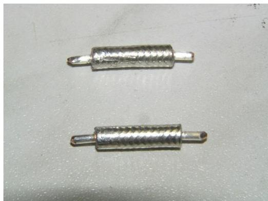
Die Gesamtlänge der Kabelstücke ist 21 mm. Dabei sind an jeder Seite 4mm abzuisolieren und danach anzuspitzen. Die Länge des Außenleiters ist somit 13,0 mm.
