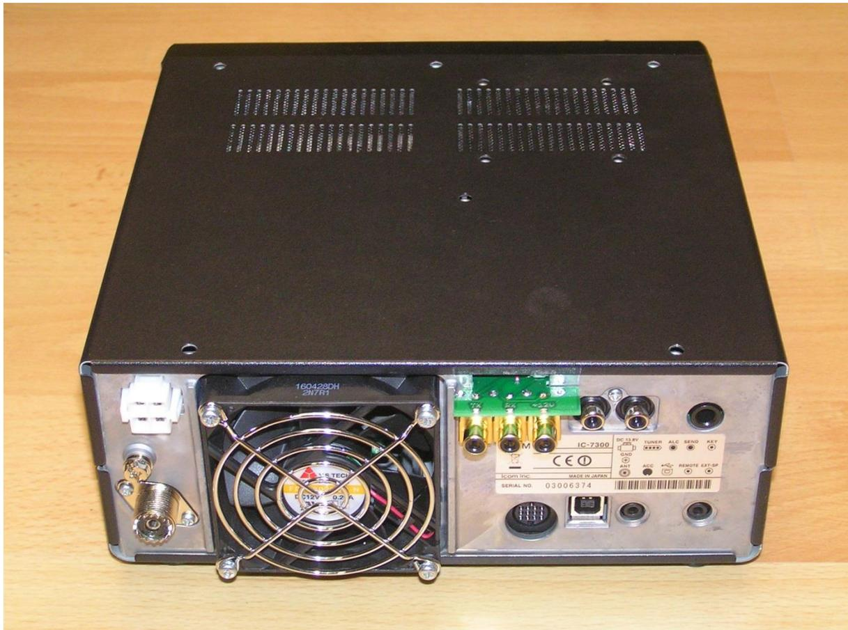
Da der Transceiver IC7300 über keinen Transverter Ausgang verfügt, wurde eine kleine Leiterplatte entwickelt um den Anschluss eines Transverters zu ermöglichen.
