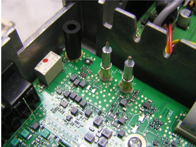
Hier ist die Abstandsrolle und die zum Test eingesteckten Kabelstücke zu sehen.
